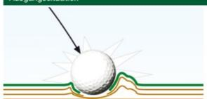
Trifft der Ball aus der Höhe auf das Grün, werden die oberen Bodenschichten an die Ränder des Einschlagloches gedrückt. Dort faltet sich die Grasnabe auf, und es entstehen Aufwerfungen rund um das Einschlagsloch. Je nach Einschlagswinkel sind diese Aufwerfungen in Flugrichtung des Balles mehr oder weniger ausgeprägt. Je senkrechter der Aufprallwinkel des Balles, umso gleichmäßiger falten sich die verdrängten Bodenschichten an den Kraterrändern auf oder pressen sich zusammen.
